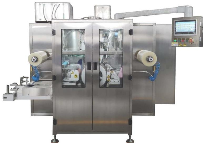
Данная линия представляет собой роторную машину для производства небольших единичных доз водорастворимых капсул. Это высокоскоростная непрерывно работающая машина. Это оптимальный вариант для начинающих, которые хотят машину с идеальной производительностью и способную производить капсулы ПВА хорошего стабильного качества для рынка.
