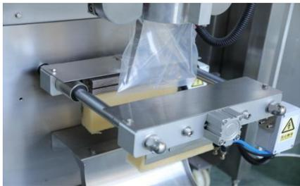
**Горизонтальная уплотнительная конструкция:**
